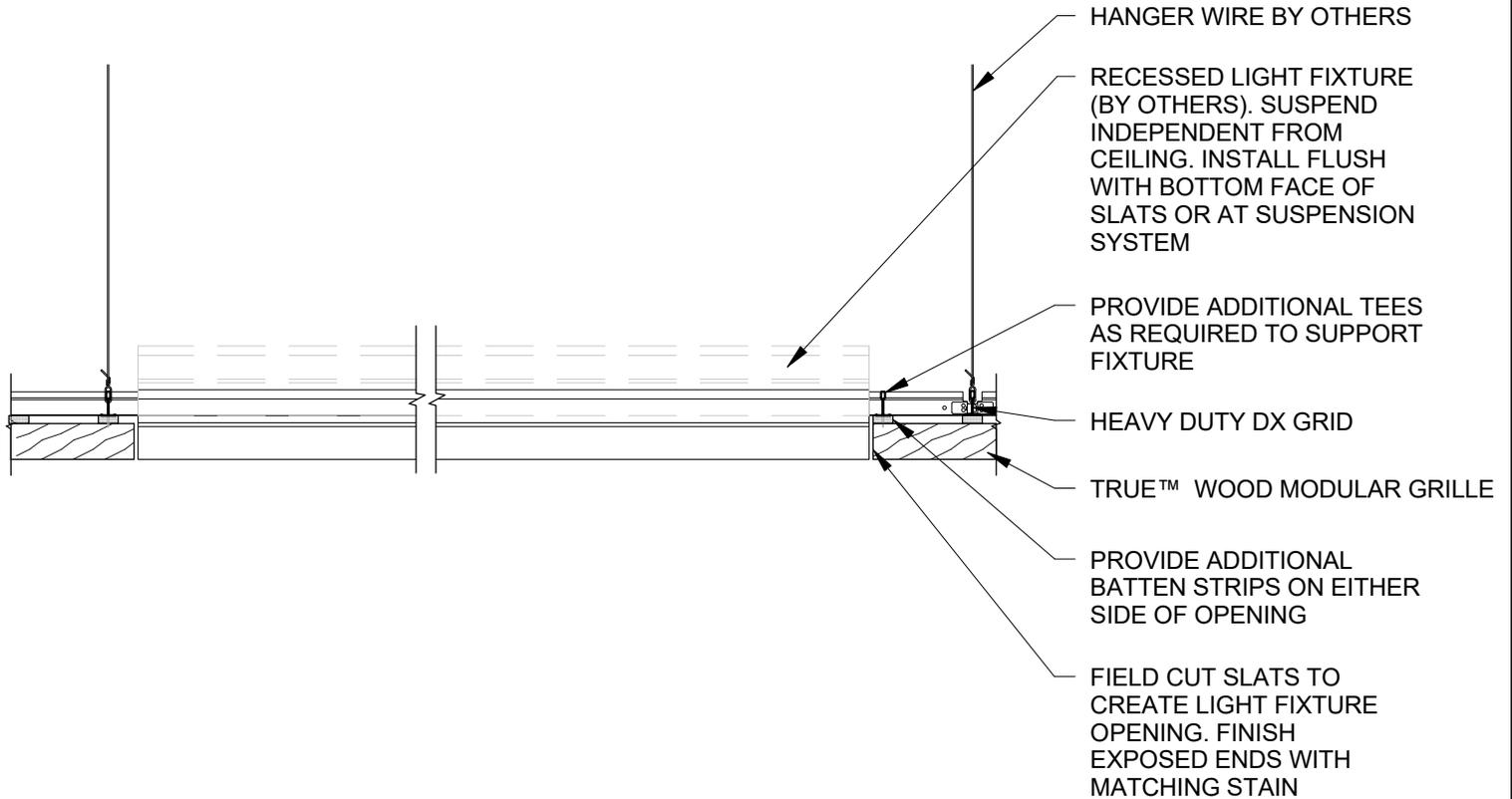
**11** **LINEAR LIGHT FIXTURE DETAIL - SECTION B - 1"**
